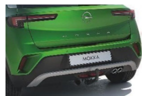
Szerszám nélkül leszerelhető vonóhorog 13 pólusú csatlakozóval
