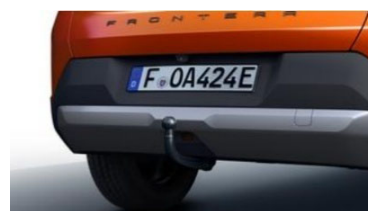
Szerszám nélkül leszerelhető vonóhorog (5 személyes kivitelhez, 17768 gyártástól)
