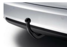
Szerszám nélkül leszerelhető vonóhorog 13 pólusú csatlakozóval
