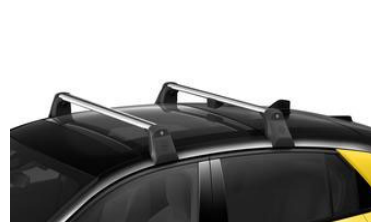
Keresztirányú alumínium tetőrudak
